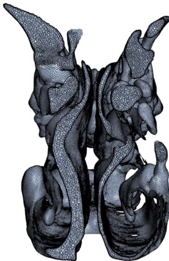
Figure 6 : Coupe au sein du domaine de calcul après maillage volumique montrant les éléments constitutifs.
