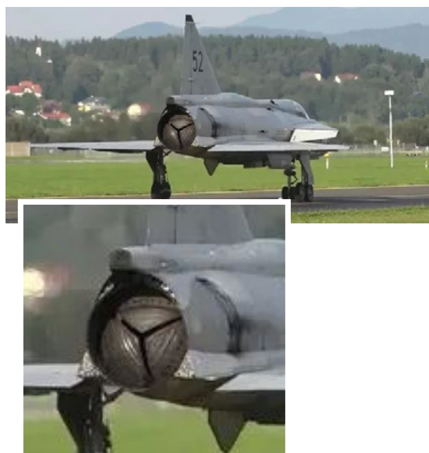
Figure 4 - Le système de reverse du Viggen déployé à l'atterrissage
