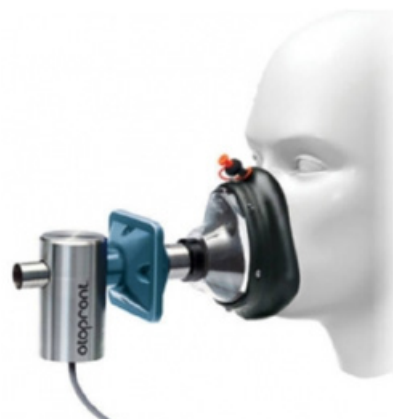
Figure 1 : Système de rhinomanométrie antérieure active. Pendant le test, le patient respire avec une fosse nasale, l'autre étant volontairement obstruée. Grâce à un capteur de pression et un débitmètre, il est possible de calculer la différence de pression entre l'entrée de la fosse nasale et le rhinopharynx, donc de mesurer la perte de charge \Delta P . [https://www.otoprnt.de]
